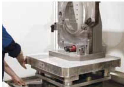
Preparazione per l'automazione: dispositivo di serraggio con interfaccia MTS.
