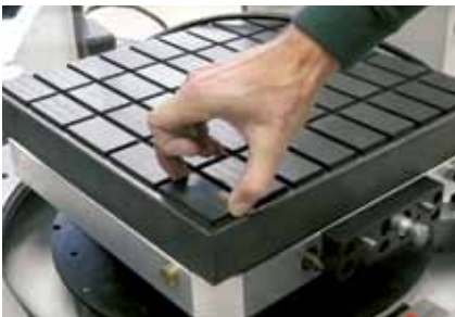
Serraggio sottovuoto su pallet MTS.
