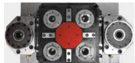
Pallet MTS \varnothing 400 mm con mandrino a 3 griffe.
