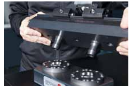
La piastra di base MTS 81 offre possibilità di serraggio flessibili in uno spazio ridotto.
