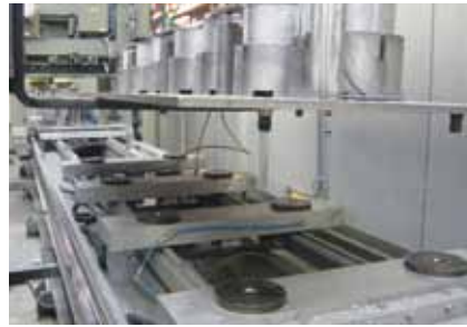
Equipaggiamento della tavola specifico del cliente con pallet MTS grande.
