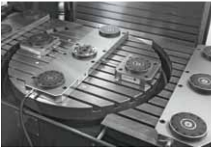
Tavola macchina con possibilità di serraggio flessibili MTS.
